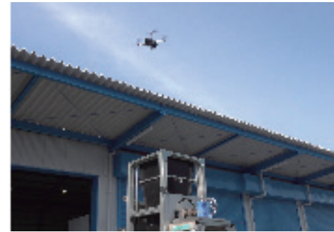
Aero Optim ピッチ回転架台を用いた上昇気流中での飛行試験 (試験場：富士エアロパフォーマンスセンター ご協力：ACSL 様 VFR 様)
