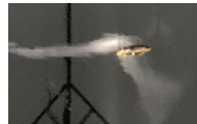
スモークを利用した機体性能試験 (試験場：富士エアロパフォーマンスセンター ご協力：Liberaware 様)
