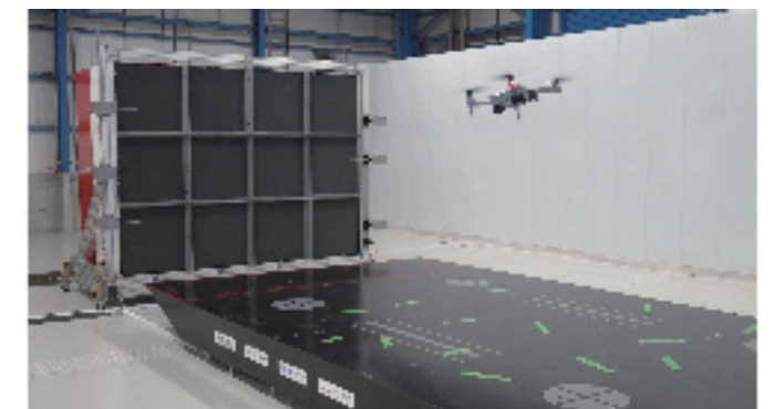
Aero Optim を用いた横風試験 (試験場：富士エアロパフォーマンスセンター ご協力：ACSL 様 VFR 様)
