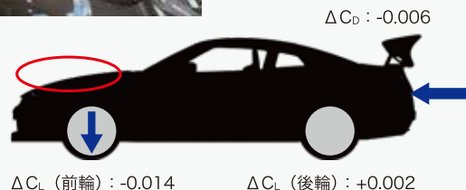
測定データの一部 (ボンネット通気孔開放の効果)
