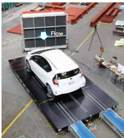
試験形態（風洞の移動による風向変更）
