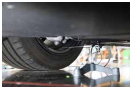
簡易熱線風速計を用いた局所的な風速計測（例）
