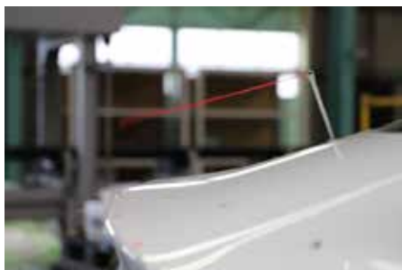
タフトによる可視化（車体後部）
